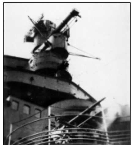
Admiral Scheer Detailaufnahme E-Messanlage
