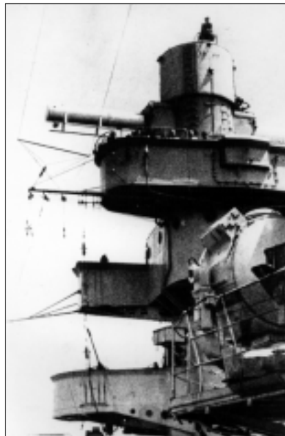
Admiral Scheer nach Umbau – mit Röhrenmast
